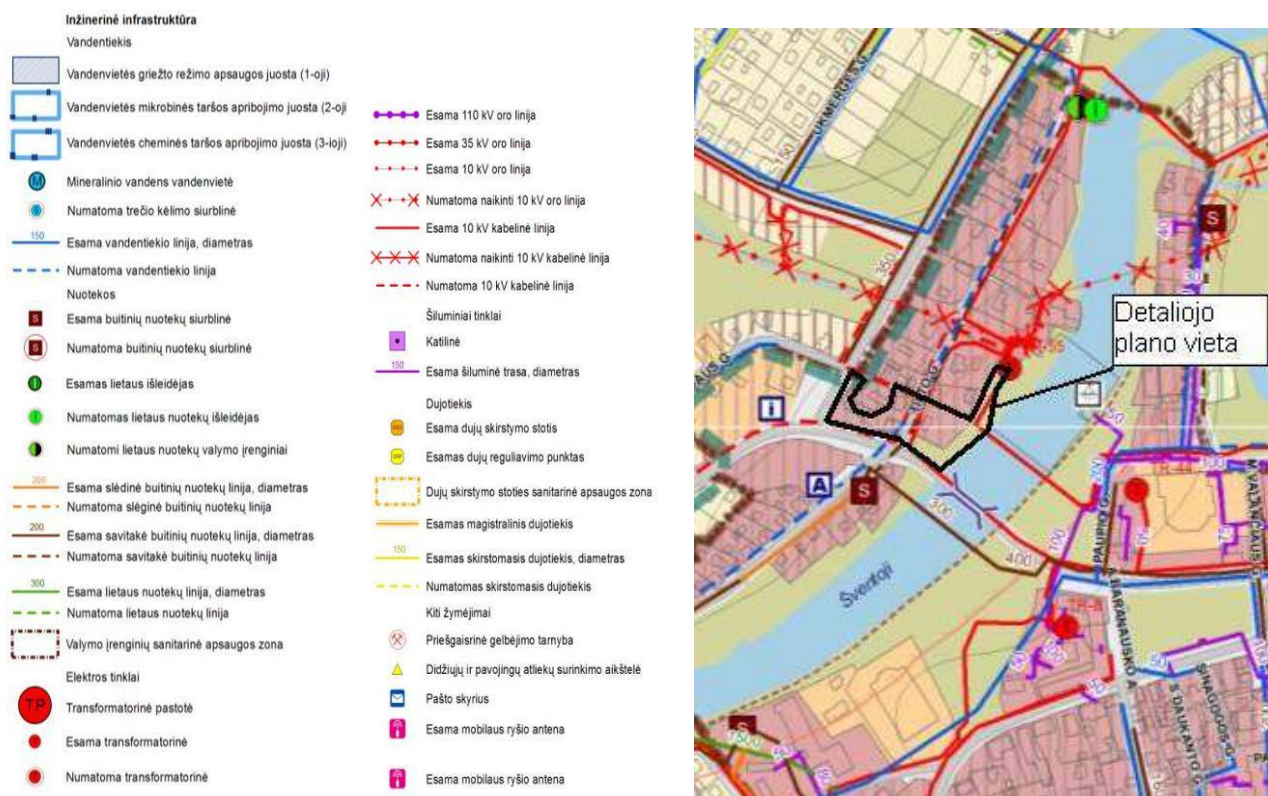
2.3 pav. Ištrauka iš Anykščių miesto bendrojo plano „Inžinerinės infrastruktūros brėžinio“. Per planuojamą teritoriją Numatoma tiesti vandentiekio liniją, Numatoma tiesti savitakę buitinių nuotekų liniją, Numatoma tiesti 10kV kabelinę liniją, per planuojamą teritoriją praeina esama 10kV kabelinė linija.
