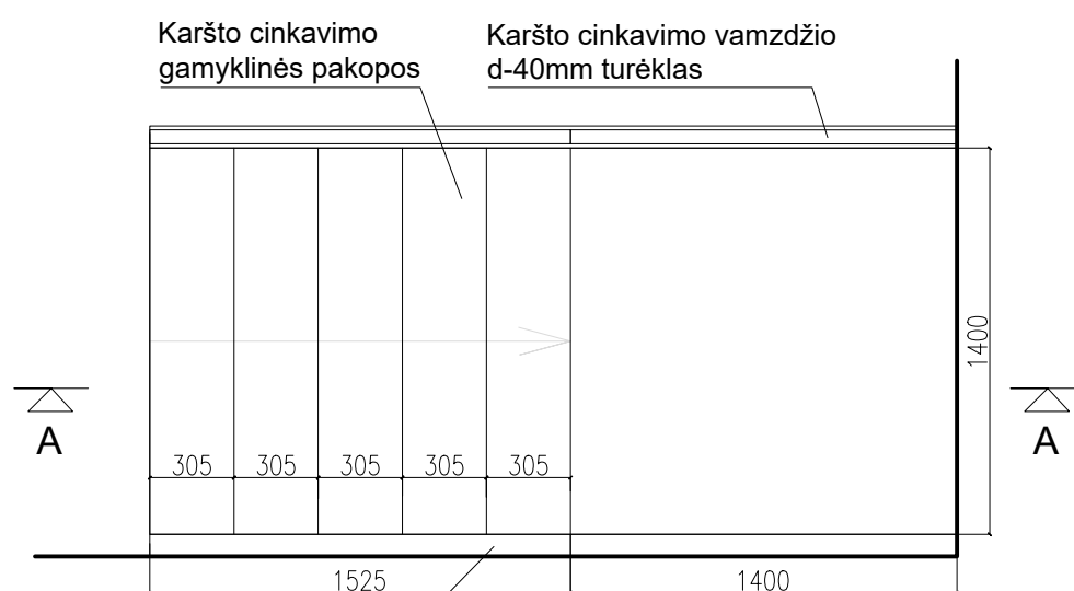
RAMPOS METALINIŲ LAIPTŲ ĮRENGIMO SCHEMA M 1:30
