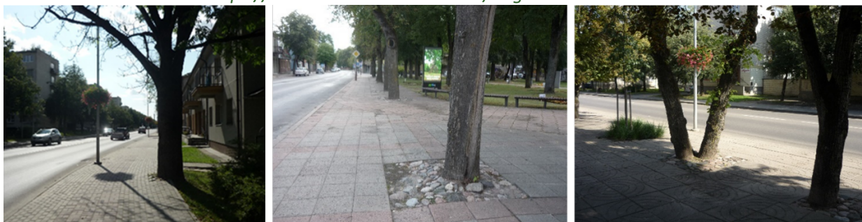
18 pav. Esama situacija: korekcijų reikalinga sisteminė klaida Anykščių mieste, itin bloginanti esamų medžių būklę – mažos, kietosiomis dangomis apribotos augimvietės ir pakeltas grunto lygis ties medžio šaknų kakleliu
