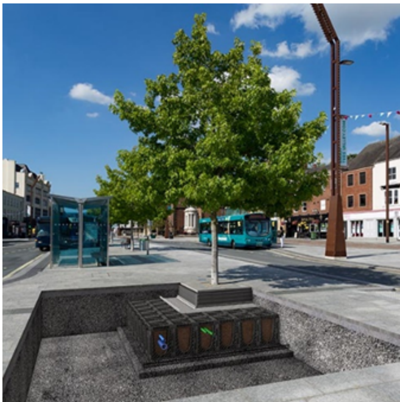
19 pav. Naujai sodinamų medžių augimvietėse dirvos struktūrą gerinanti infrastruktūra. Šaltinis: https://greenblue.com/gb/products/arborflow/
