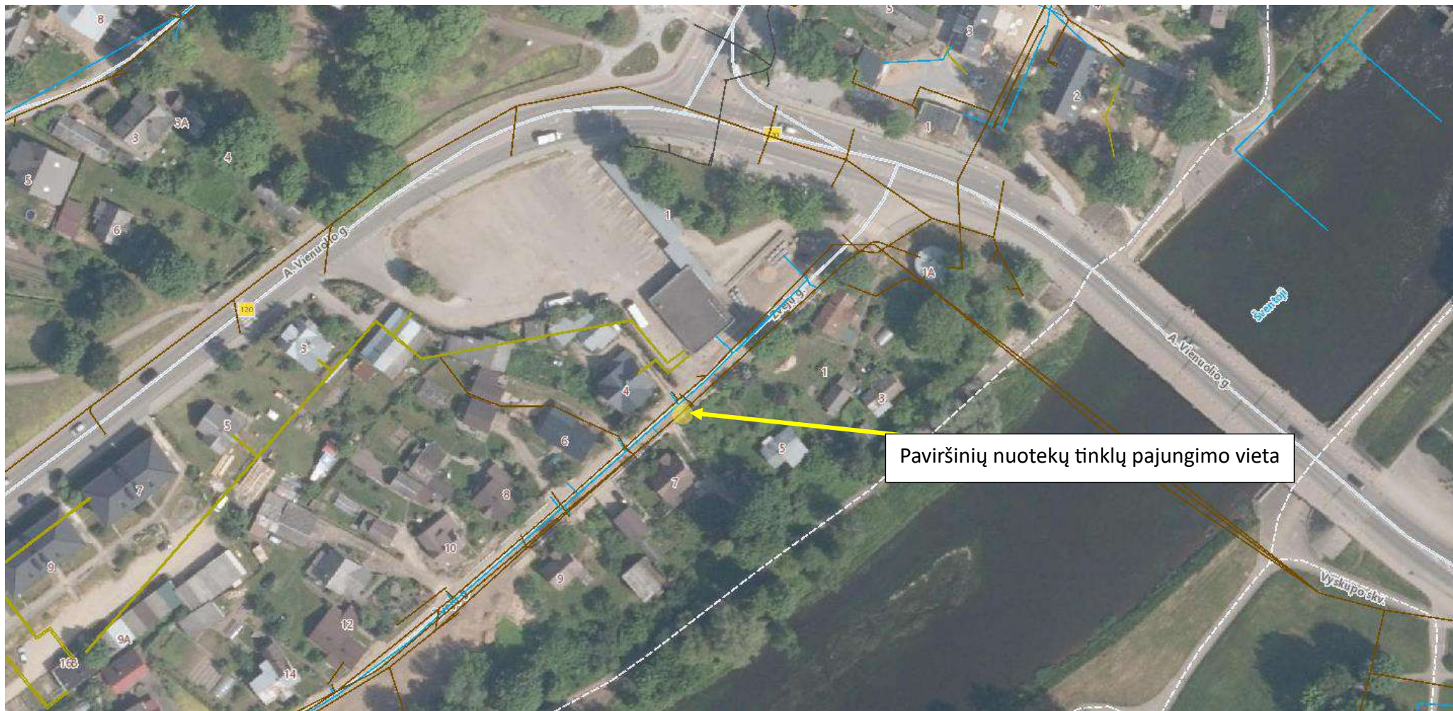
Paviršinių nuotekų tinklų pajungimo schema- A. Vienuolio g. 1, Anykščių m.
