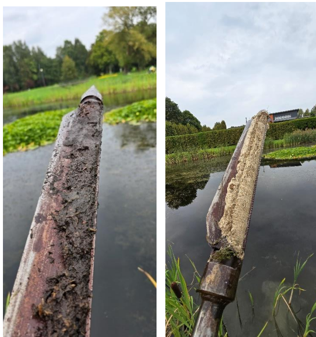
11 pav. Anykščių miesto parko kūdros uždumblėjimo bei dugno grunto tyrimai. Šaltinis - A. Balevičiaus nuotr.
